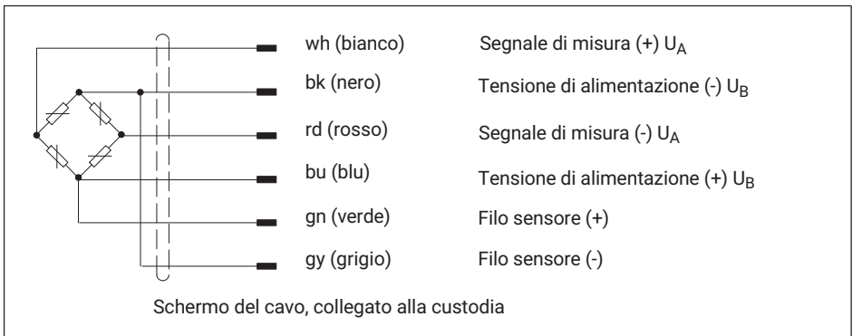
Fig. 8.1 Collegamento circuito a 6 fili
