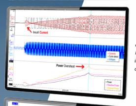
Pour optimiser le rendement d'un moteur électrique, ce dernier doit être aiusté à son environnement réel et dans des conditions dynamiques. Les données de mesure enregistrées et les mesures de puissance à l'échelle du demi-cycle permettent aux ingénieurs d'appréhender l'efficacité dynamique dans la réalité.
