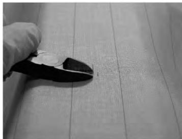
Bild 5.3.4-1: Kürzen der Pins mit einem Seitenschneider
