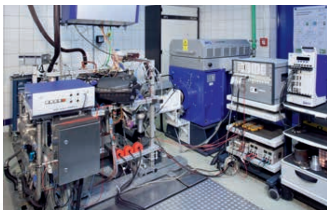
HBM-Prüf- und Messausrüstung auf einem Prüfstand für Hybridmotoren, an der Technischen Universität Darmstadt, Institut für Verbrennungskraftmaschinen und Fahrzeugantriebe (vkm).
