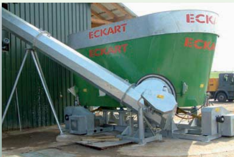
Abb. 1: Substratlager mit Einbringsystem (Förderschnecke)
