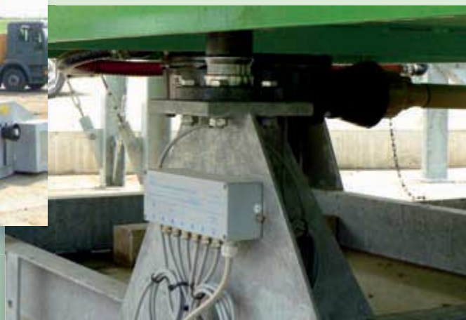
Abb. 2 und 3: RTN-Wägezellen mit Lastfuß (oben) über Klemmkasten (unten) parallel geschaltet
