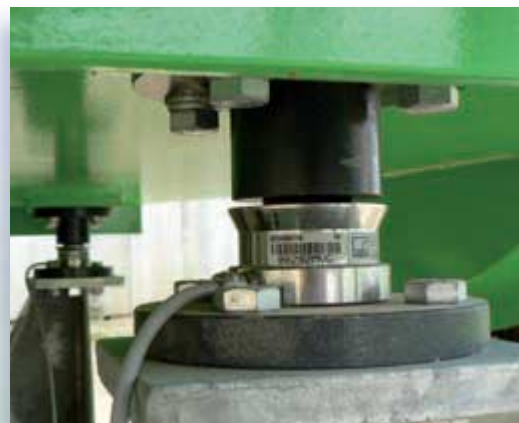
Abb. 2 und 3: RTN-Wägezellen mit Lastfuß (oben) über Klemmkasten (unten) parallel geschaltet
