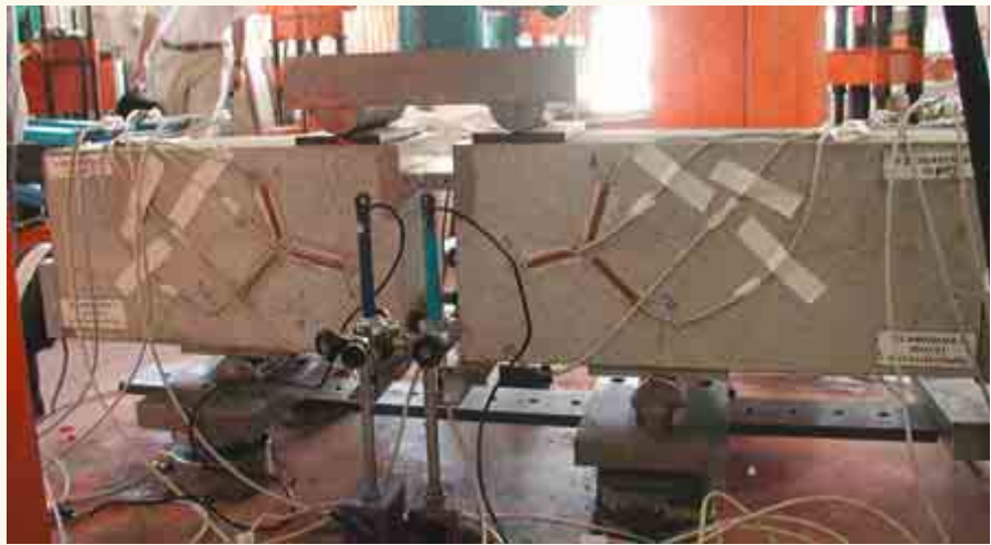
Fig. 1 : Blocs de béton munis de jauges d'extensométrie, de capteurs de déplacement et de pesons
