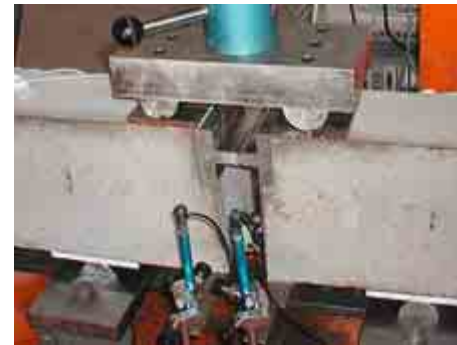
Fig. 5 (à gauche) : Des capteurs de force C6A/200 kN de HBM mesurent les forces s'exerçant aux extrémités de la barre d'armature
