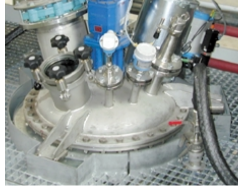
120 kg-Reaktionsbehälter auf HLC-Wägezellen mit Easy top-Elastomerlager
