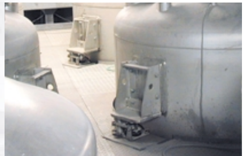
10t-Mischbehälter auf RTN-Wägezellen mit Behältermodul MLAR
