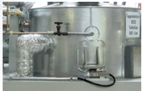
300l-Tagesbehälter auf HLC-Wägezellen mit Easy top-Elastomerlager
