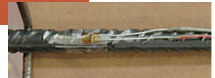
Abb. 6, unten: HBM-DMS LY41-3/120 messen die Längsdehnungen im Bewehrungsstab
