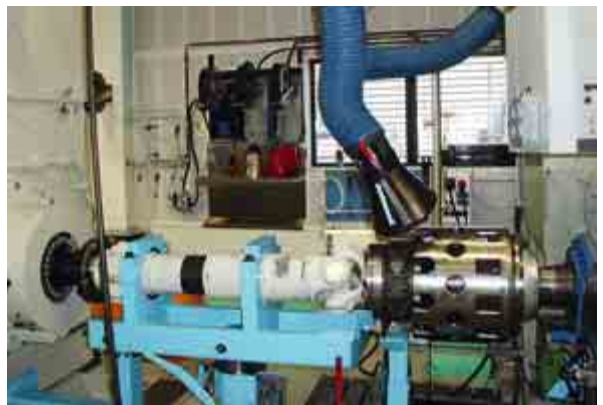
Fig. 3 : Raccordement de l'échantillon d'essai
