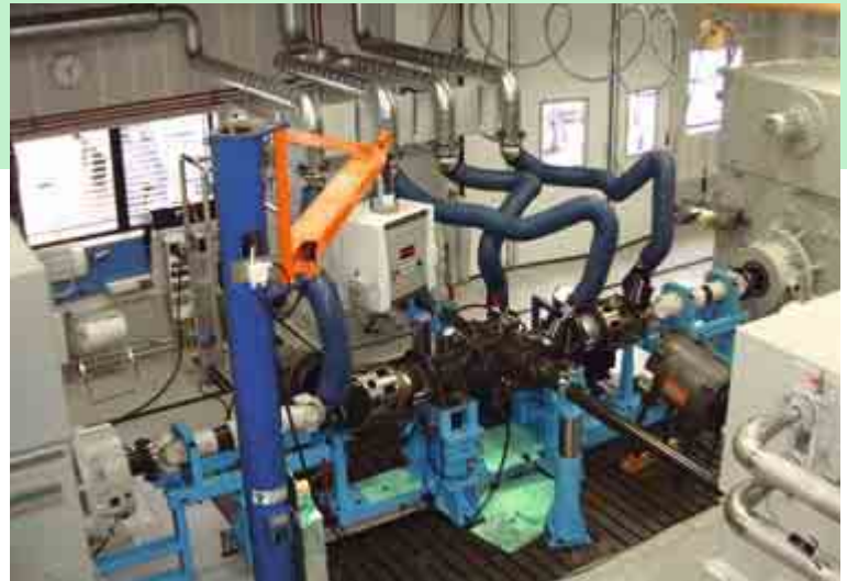
Fig. 2 : Banc d'essai avec une boîte de vitesses d'essieu arrière comme échantillon d'essai
