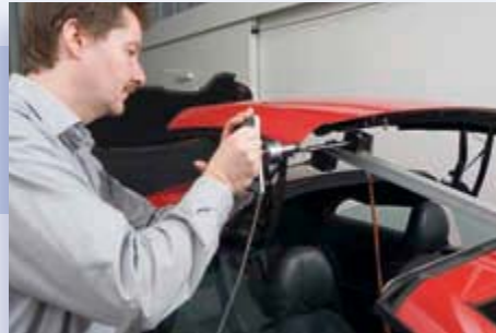
Abb.1-3: Messaufbau am Komponentenprüfstand für das Hardtop
