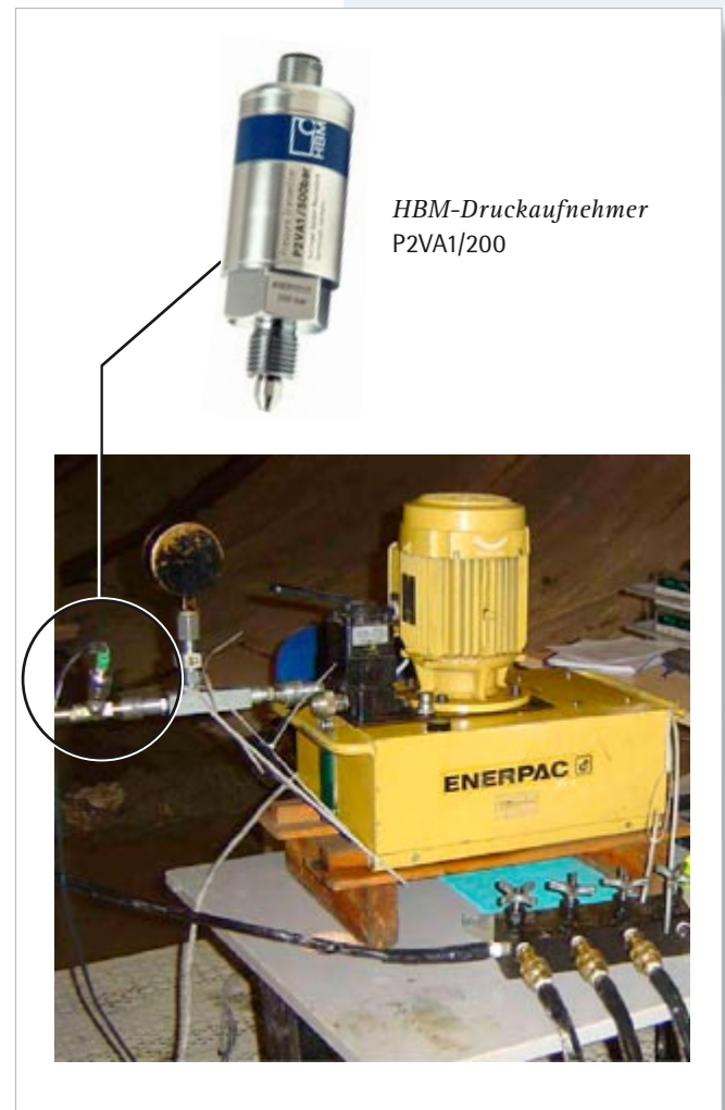
Abb. 6: Ölpumpe, Ventile und Druckaufnehmer
