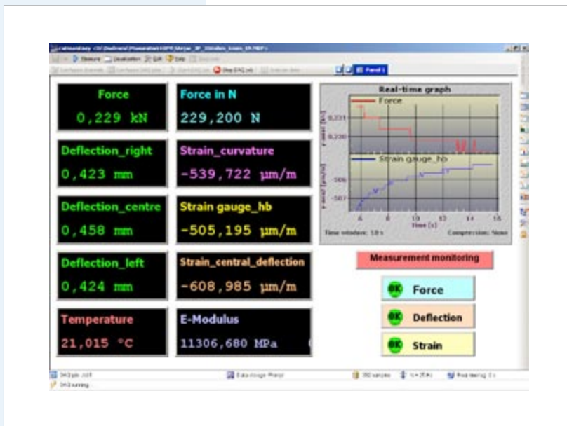
Abb. 3: Benutzeroberfläche für die Datenerfassung und Grenzwertüberwachung (catman®Easy)
