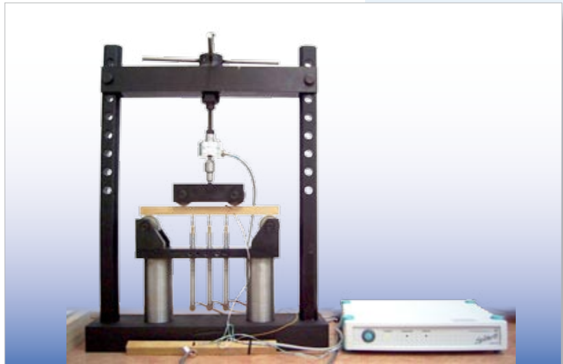
Abb. 1: Versuchsanordnung für den 4-Punkt-Biegeversuch
