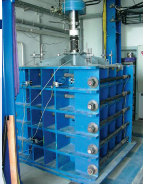
Fig. 5: Large-scale axial device incl. loading structure at the Institut für Geotechnik und Markscheidewesen
