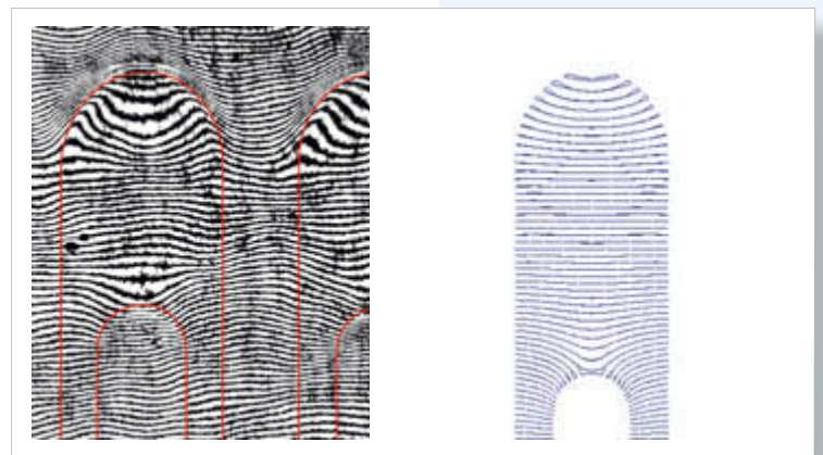
Abb. 10: Isotheten-Felder für Umlenkstellen und Stege unter Längsdehnung aus dem Experiment (Stockmann [2]) und aus der FE-Berechnung (Tao [3])
