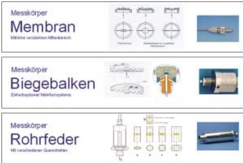
Meßkörperaufbau und unterschiedliche Meßprinzipien von Druckaufnehmern für unterschiedliche Meßbereiche. Grafik: HBM
