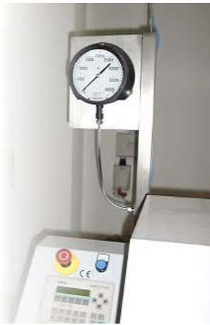
Fig. 4: Machine de découpe au jet d'eau équipée d'un manomètre de pression conventionnel (monté sur une pompe haute pression)
