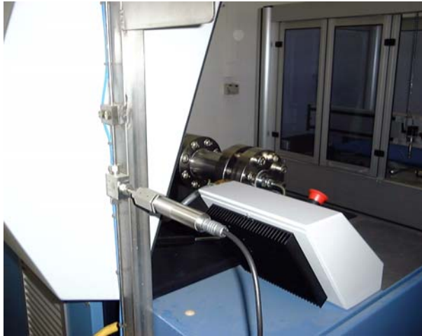
Fig. 6: Utilisation d'un P3MBP/5000 bar dans une pompe haute pression
