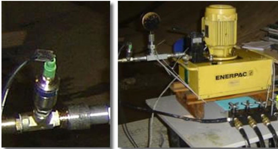
Fig 4 : Pompe à huile, valves et capteurs de pression
