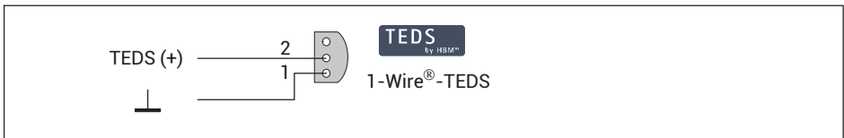
Abb. 2.1 Ansicht des TEDS-Chips von unten (Lötseite)
