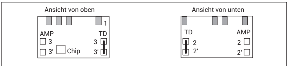
Abb. 2.16 Ansicht des TEDS-Moduls mit Anschlussbelegung
