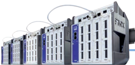
PMX, el controlador PLC CODESYS modular con visualización integrada
