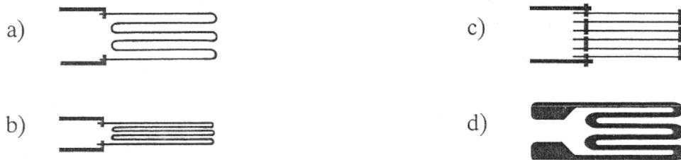
**Figura 3.3-5: Distintas formas de rejillas y métodos para reducir la sensibilidad transversal**
