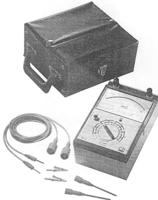
**Figura 4.2-3: Ohmímetro de bolsillo TO 3 para la medición de la resistencia de continuidad eléctrica y de la resistencia de aislamiento de las bandas extensométricas instaladas**
