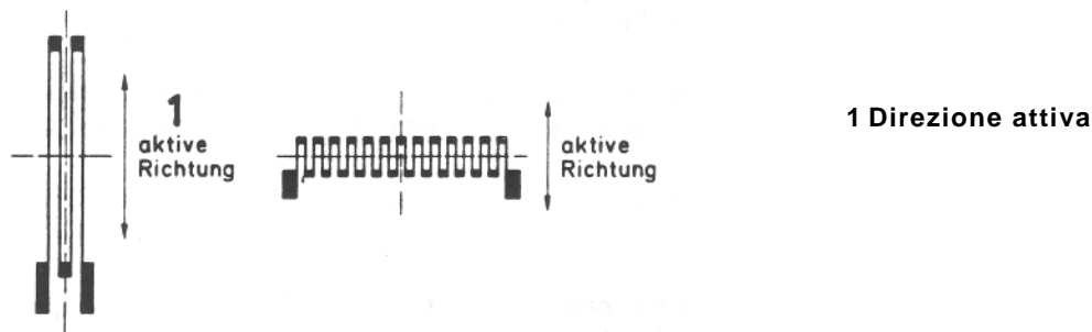
Figura 3.3-3: La direzione "attiva" di un estensimetro
