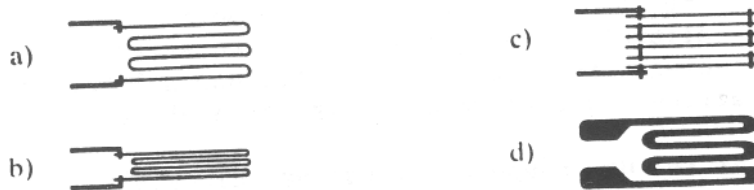
Figura 3.3-5: Diverse forme di griglia e misure per evitare la sensibilità trasversale
