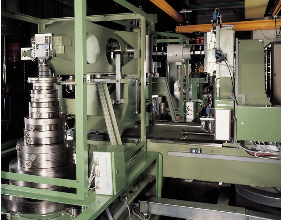
Bild 7.1 Kalibrieranlage nach dem Hebelarm-Masse-Prinzip
