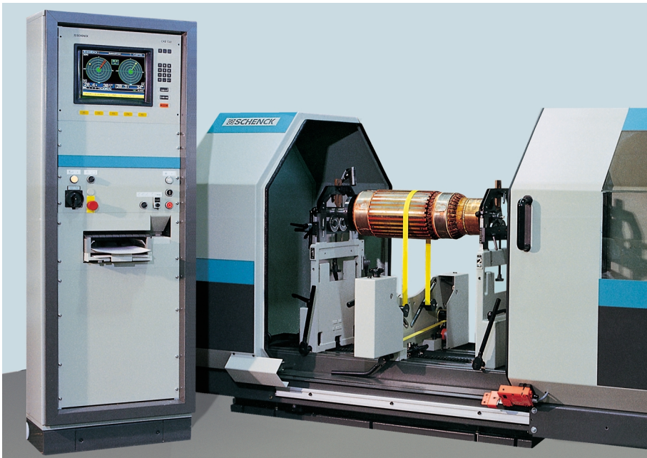
Bild 4.20 H 4 BU Universalauswuchtmaschine mit horizontaler Achse Foto mit freundlicher Genehmigung der Schenck ROTEC GmbH
