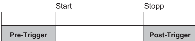
Abb. 8.1 Start und Stopp einer Messung mit Trigger. Es werden alle Messwerte zwischen Start und Stopp sowie während der Pre- und Post-Triggerzeiten aufgezeichnet
