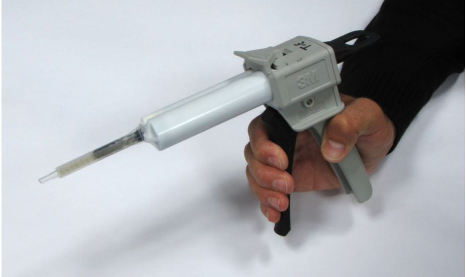
Abb. 3.4 Fertiger Applikator mit aufgesetzter Mischdüse (Mixing Nozzle)
