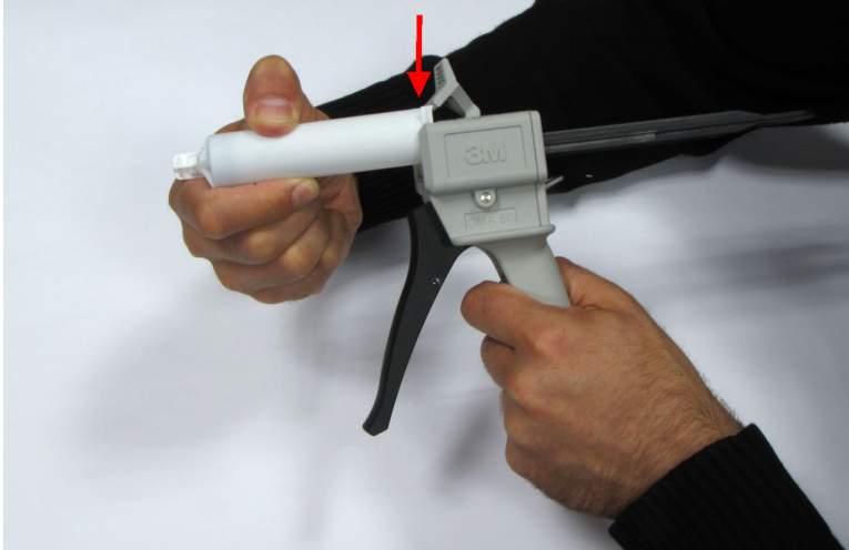
Fig. 3.2 Mise en place de la cartouche de colle
