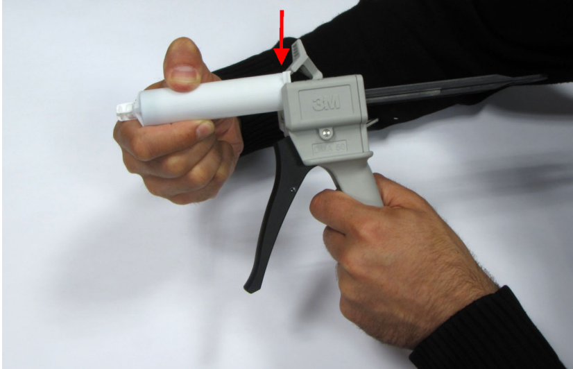
Abb. 3.2 Kartusche mit Klebstoff einsetzen
