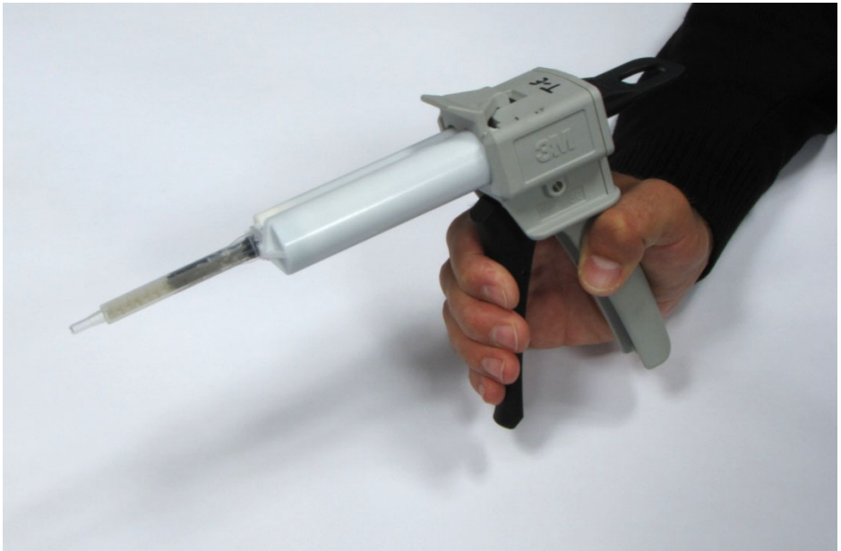
Fig. 3.4 Applicateur prêt avec embout mélangeur (Mixing Nozzle) en place
