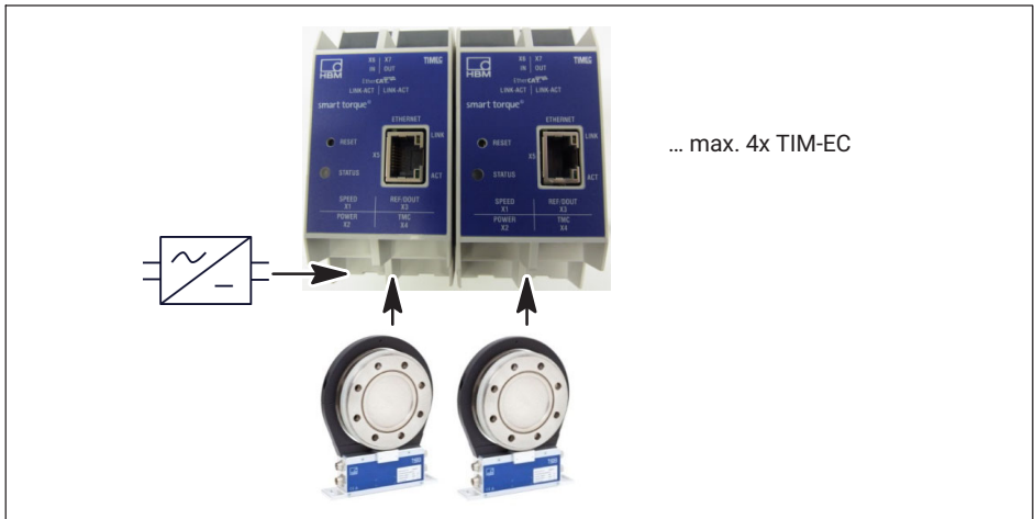
Abb. 7.1 Betrieb von mehreren TIM-EC in Reihenschaltung
