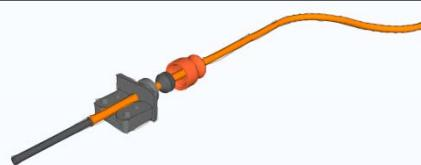
Anschließend setzen Sie auch vorsichtig den Zwischenmantel ab. Achten Sie hierbei darauf, dass Sie die Isolierung der Adern nicht verletzen.
