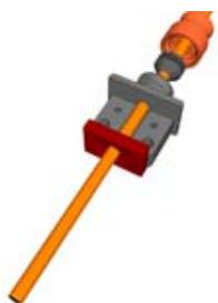
**Das Absetzen des Kabelmantels und Abisolieren der Litzen muss mit den Längen erfolgen, die der Hersteller der Thermokupplung empfiehlt!**
