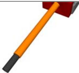
Anschließend setzen Sie auch vorsichtig den Zwischenmantel ab. Achten Sie hierbei darauf, dass Sie die Isolierung der Adern nicht verletzen.
