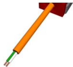
Legen Sie jetzt die Litzenenden auf die Kontakte der Thermokupplung auf. Achten Sie dabei auf die Polarität und beachten Sie die Montage-Hinweise des Herstellers der Kupplung.
