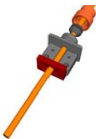
**La gaine de câble doit être retirée et les fils torsadés dénudés sur les longueurs recommandées par le fabricant de l'accouplement thermo-couple !**
