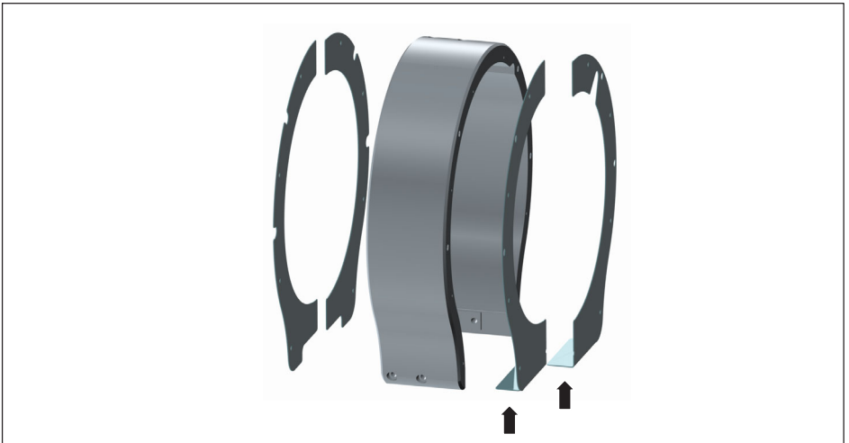
Abb. 8.9 Abgewinkelte Abdeckbleche (Messbereiche 5 \text{ kN} \cdot \text{m} und 10 \text{ kN} \cdot \text{m} )
