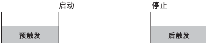
图8.1 使用触发器启动和停止测量。记录启动与停止之间的所有测量值、以及在预触发和后触发期间的测量值
