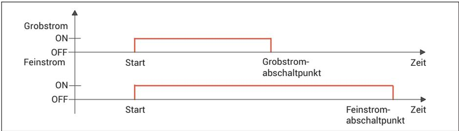
Abb. 11.3 Füllzyklus bei Ventilsteuerung Grob+Fein
