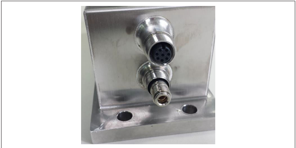
Abb. 5.1 Steckeranschluss und (darunter) Schnellkupplung für den Luftdruckausgleich
