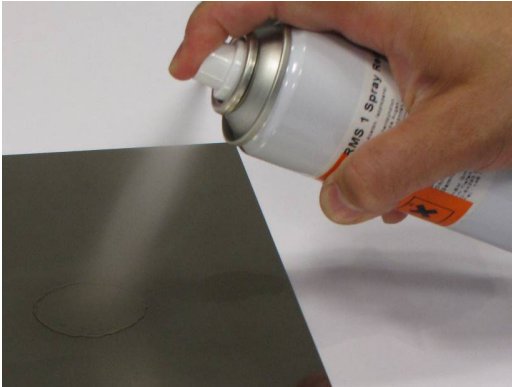
Fig. 2.3 Pulvérisation de 1-RMS sur un spécimen
