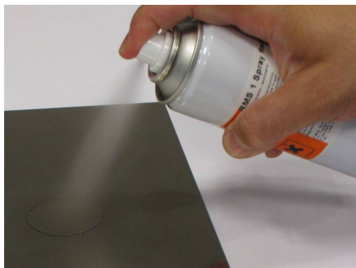
図2.3 試験体上に1-RMSクリーナーを噴射する
