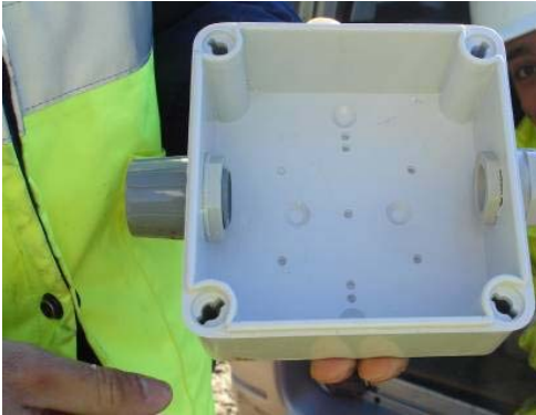
Abb. 2.5 Beispiel eines Schutzgehäuses zum Schutz optischer Steckverbinder
