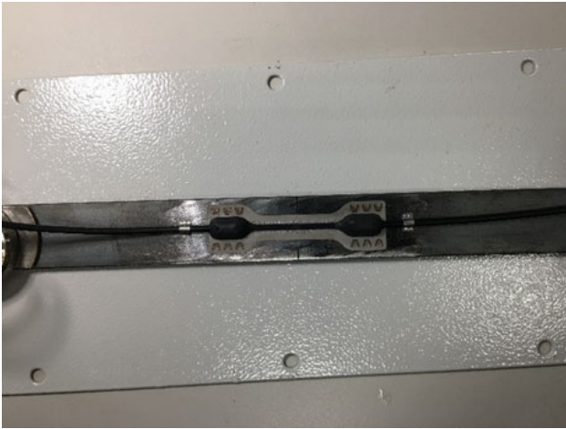
Abb. 2.19 Angeschweißter Sensor mit Stahlschellen
