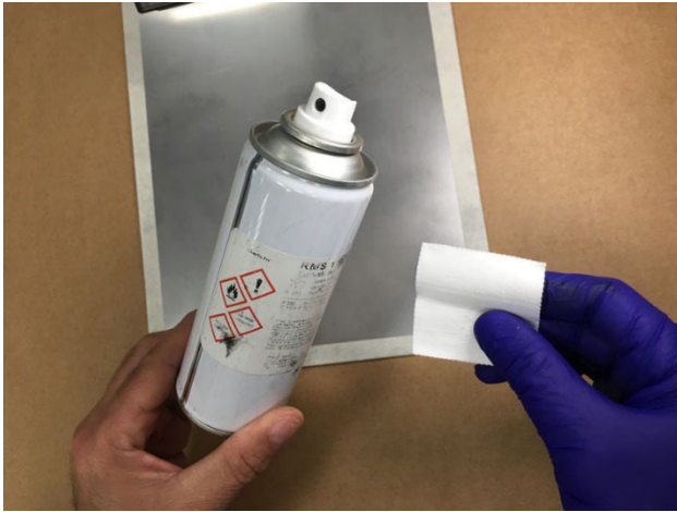
Abb. 2.5 Verwenden von Reinigungsmittel RMS1 und Vliesstoff-Pads
