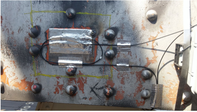
Abb. 2.33 Mit ABM75 geschützter Sensor
