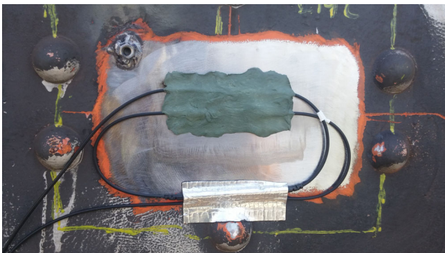
Abb. 2.32 Mit AK22 geschützter Sensor
