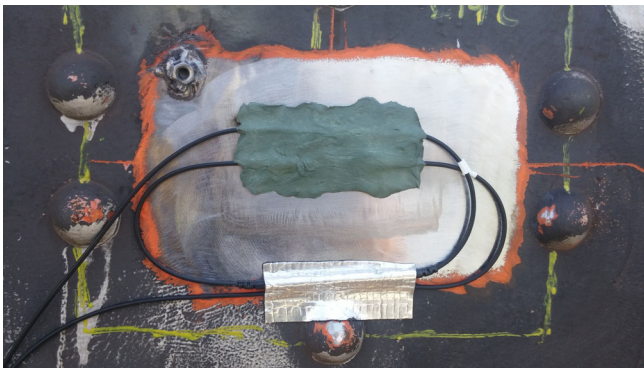
Fig. 2.32 Capteur protégé avec de l'AK22
