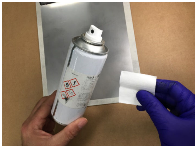
Fig. 2.5 Utilisation du nettoyant RMS1 et de morceaux de non-tissé
