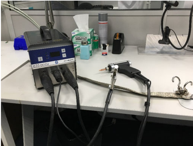
Fig. 2.12 Poste à souder par impulsion recommandé
