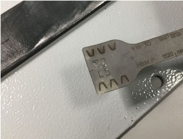
Fig. 2.13 Confirmation que les paramètres de soudage sont corrects
