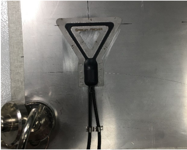
Fig. 2.27 FS62WSR avec clips en acier
