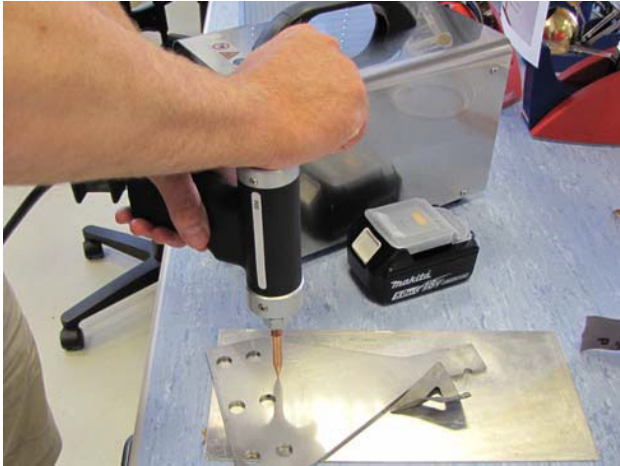
Fig. 2.15 Position de soudage correcte
