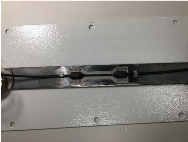
Fig. 2.19 Capteur soudé avec clips en acier
