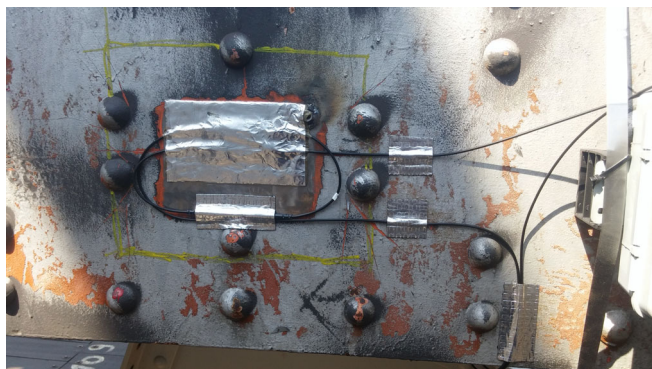
図2.33 ABM75で保護されたセンサ
