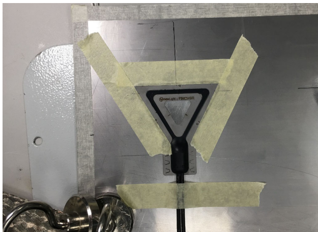
図2.22 位置合わせ後テープで仮止めされたFS62WSR
