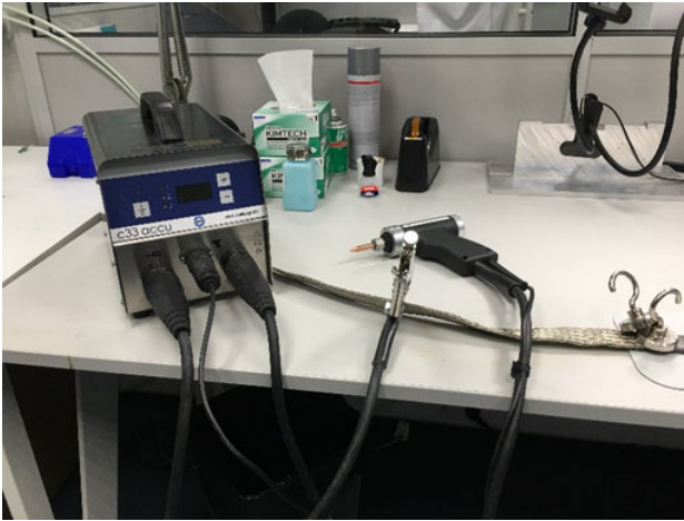
図2.12 推奨されるインパルス溶接装置
