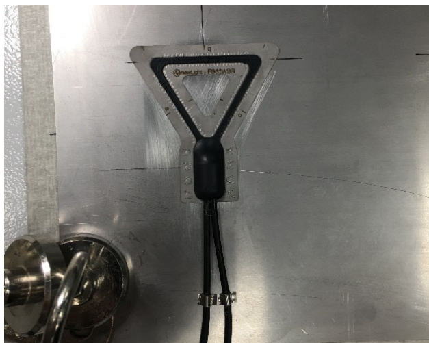
図2.27 スチールクリップを取り付けたFS62WSR
