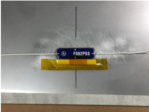
Abb. 2.8 Ausrichten und Platzieren des FS62PSS
