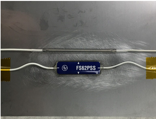
Abb. 2.22 Positionieren des Temperatursensors
