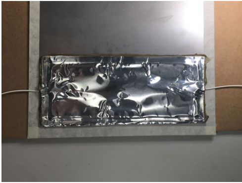
Abb. 2.31 Vollständig abgedeckte Messstelle
