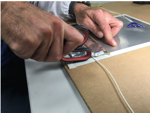
Abb. 2.30 Auflegen und Andrücken der Abdeckfolie ABM75
