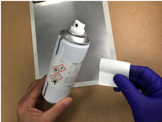
Abb. 2.3 Verwenden von Reinigungsmittel RMS1 und Vliesstoff-Pads
