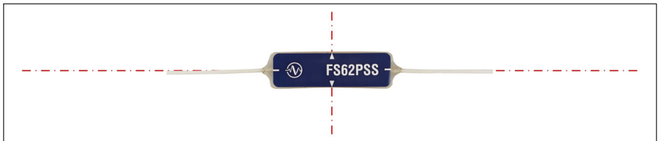
Abb. 2.6 Ausrichtmarkierungen des Sensors FS62PSS
