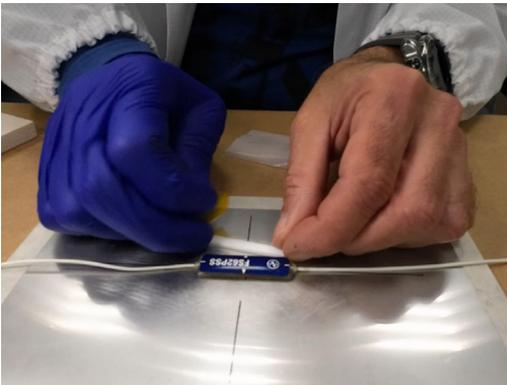
Fig. 2.13 Retrait de l'aide à l'installation en polymère fluoré
