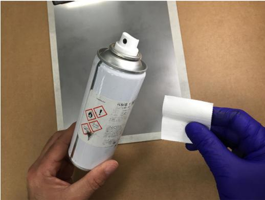
*Fig. 2.3 Utilisation du nettoyant RMS1 et de morceaux de non-tissé*
