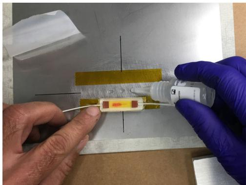
*Fig. 2.10 Repli du FS62PSS et application de la colle Z70*
