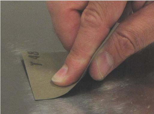
*Fig. 2.4 Ponçage de la surface du spécimen*
