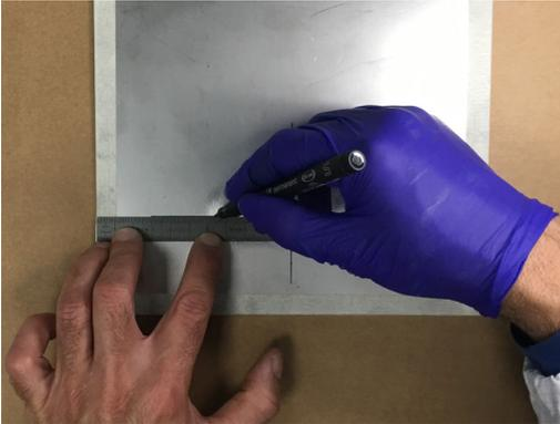
Fig. 2.7 Marquage de la position du capteur
