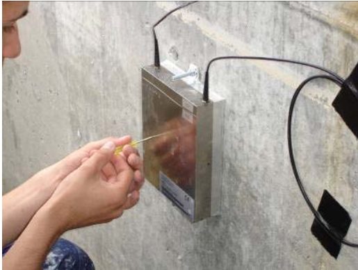
Abb. 2.9 Vordere Sicherungsschraube (Nummer „2“)
