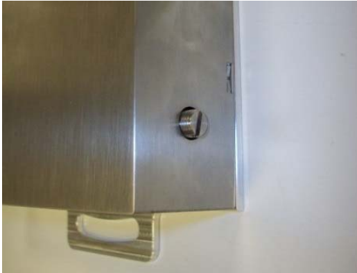
Abb. 2.8 Sicherungsschraube der Pendelmasse (Nummer „1“)
