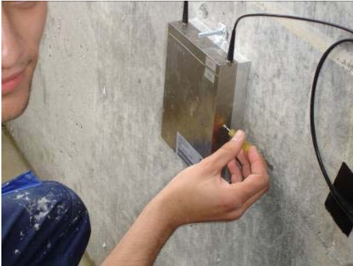
Abb. 2.10 Seitliche Sicherungsschraube (Nummer „3“)
