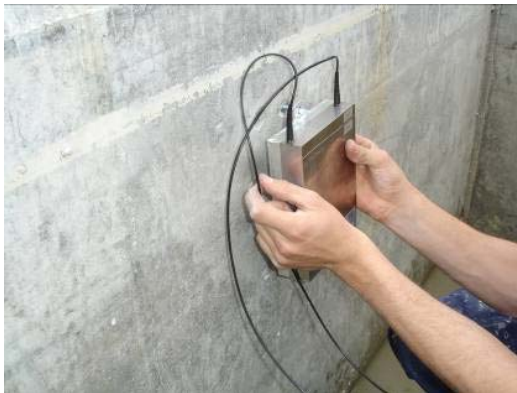
Abb. 2.4 Anbringen des Sensors an den Halterungen
