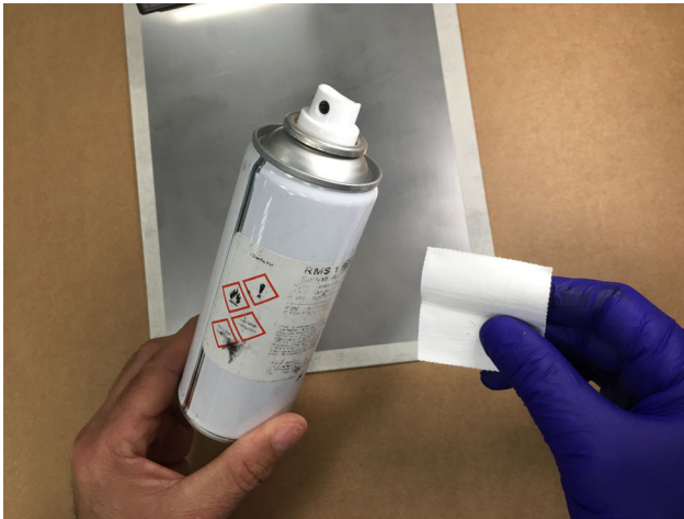
Abb. 2.5 Verwenden von Reinigungsmittel RMS1 und Vliesstoff-Pads
