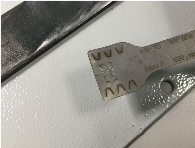
Abb. 2.13 Bestätigung der richtigen SchweißEinstellungen
