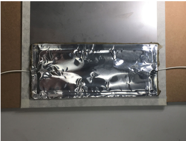
Abb. 2.31 Vollständig abgedeckte Messstelle
