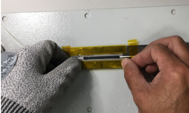
Abb. 2.11 Sorgfältiges Befestigen des Sensors sorgt für problemloses Anschweißen
