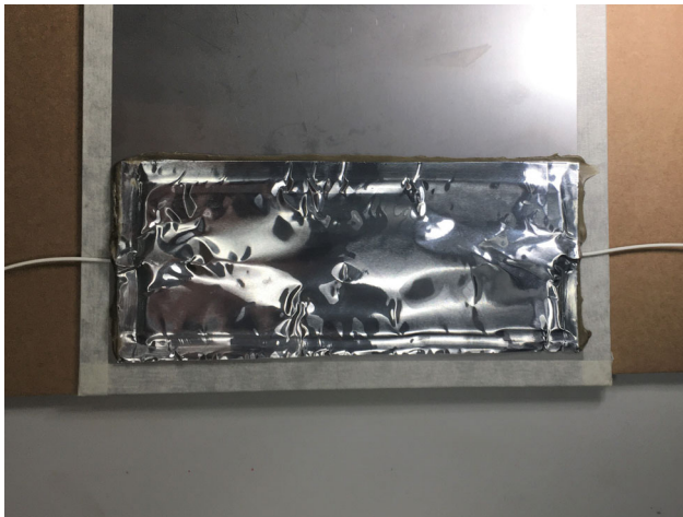
Fig. 2.31 Point de mesure entièrement recouvert
