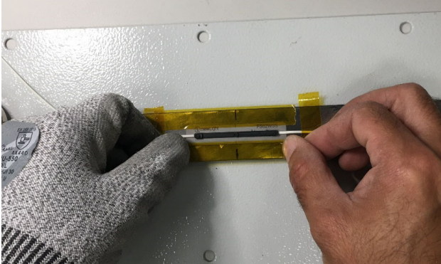
Fig. 2.11 Soigneuse fixation du capteur pour assurer un bon processus de soudage
