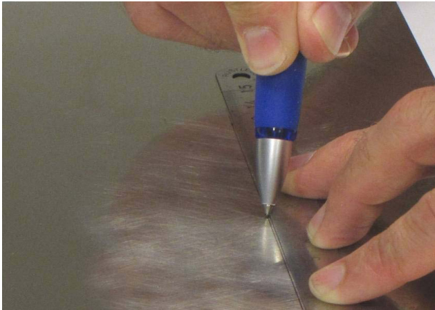
Fig. 2.8 Traçage des lignes de marquage
