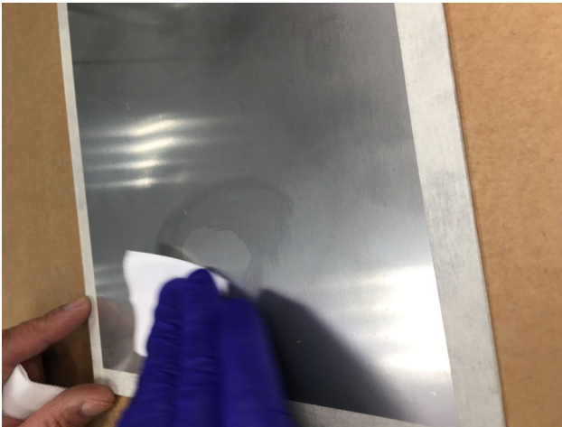
Fig. 2.6 Nettoyage de la surface
