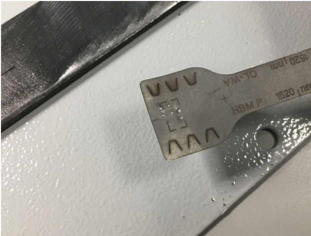
Fig. 2.13 Confirmation que les réglages de soudage sont corrects
