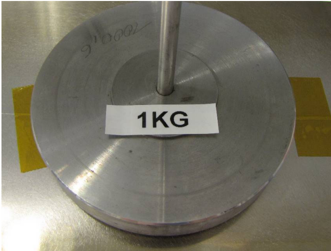
Abb. 2.11 Gewicht auf der FBG-Klebefläche der Glasfaser
