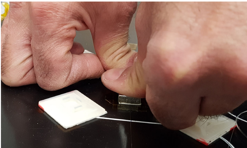
Abb. 2.19 Einen gleichmäßigen Druck über das gesamte FBG ausüben.
