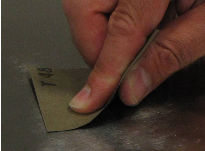
Abb. 2.3 Aufrauen der Oberfläche mit Schleifpapier
