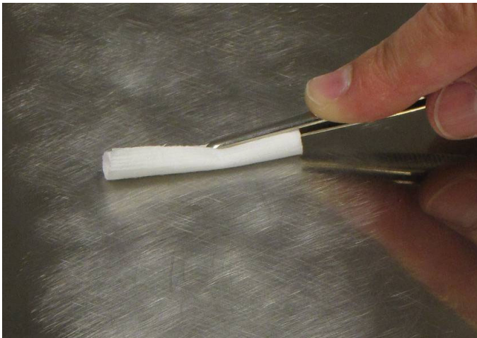
Abb. 2.4 Reinigen der aufgerauten Installationsfläche
