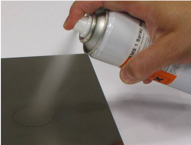
Abb. 2.1 Sprühen von 1-RMS auf die Probe
