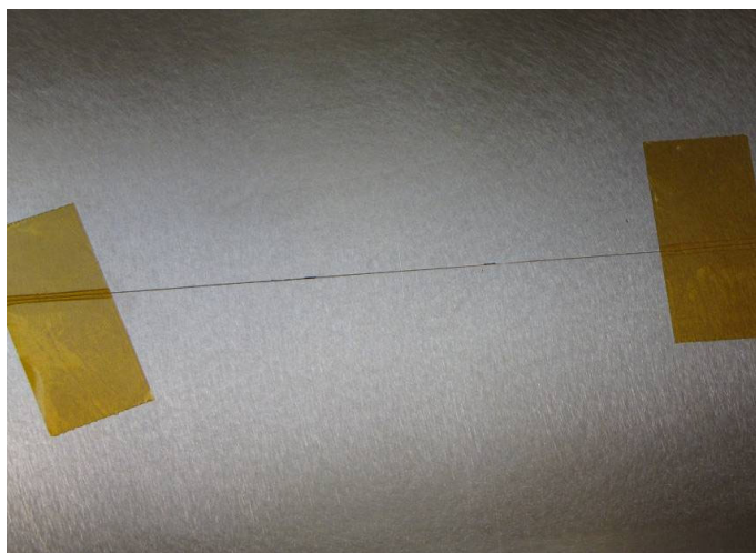
Fig. 2.8 Fixation de la fibre optique
