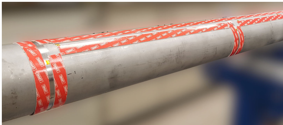
Fig. 2.20 Gorge le long de la fibre créée avec du ruban mousse (option)
