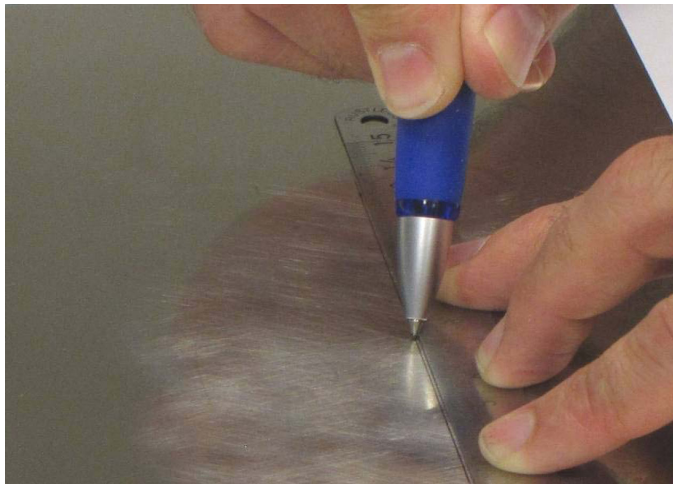
Fig. 2.6 Traçage des lignes de marquage
