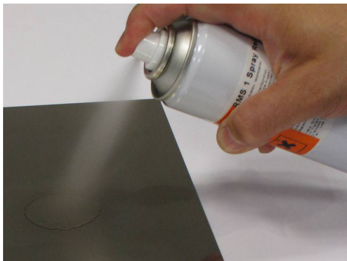
Fig. 2.1 Pulvérisation de 1-RMS sur un spécimen
