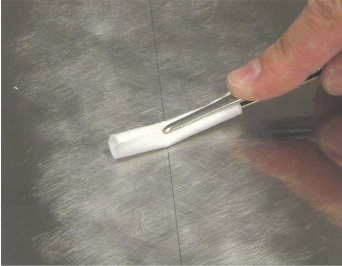
図2.7 取付箇所の仕上げクリーニング
