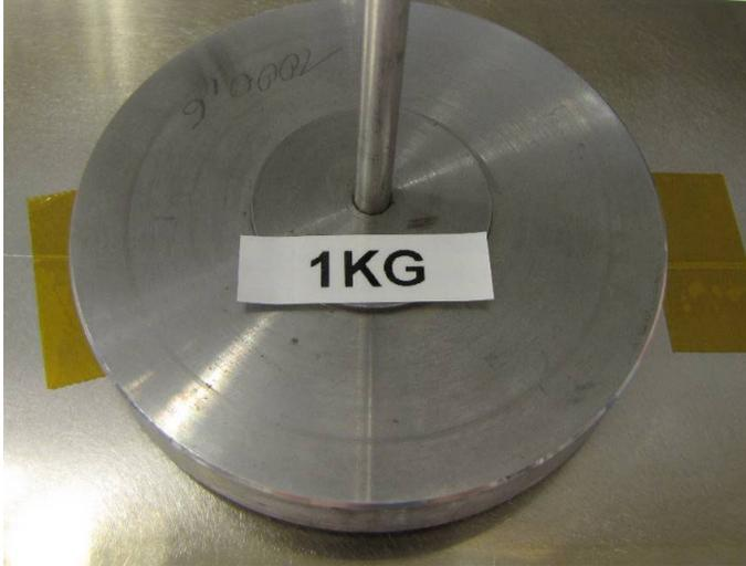
図2.11 光ファイバFBGセンサの接着面上に荷重をかける
