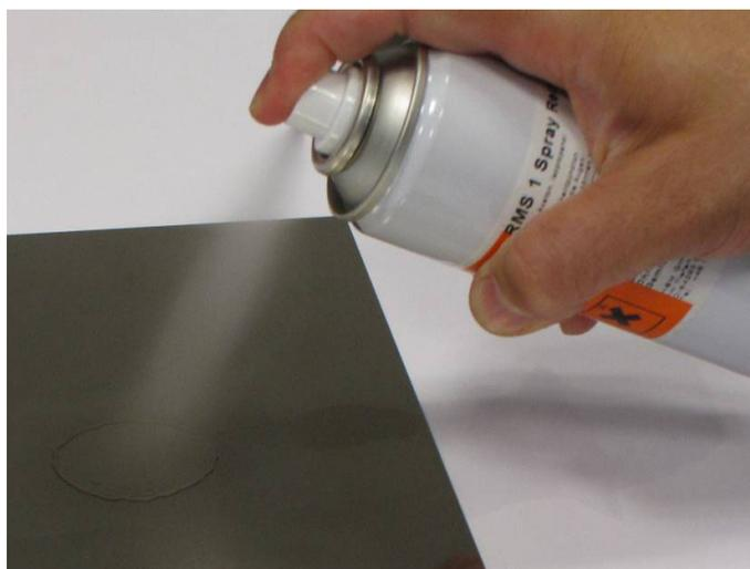
図2.1 試験体上に1-RMSクリーナーをスプレーで塗布する
