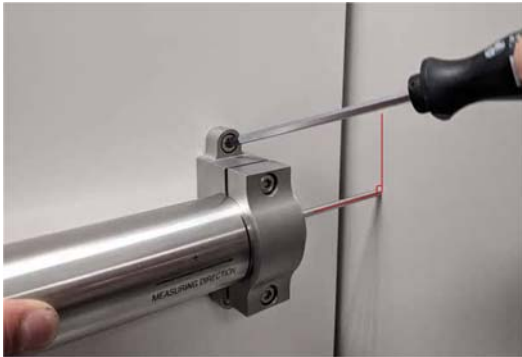
Abb. 2.6 Festziehen der Sensorhalterungen
