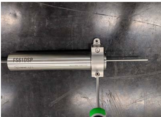
Abb. 2.5 Befestigen der Sensorhalterungen
