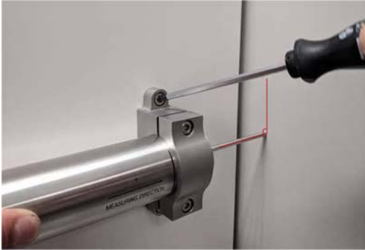
Fig. 2.6 Serrage des supports du capteur
