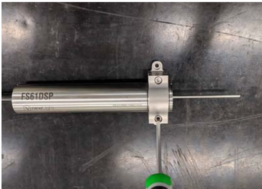
Fig. 2.5 Fixation des supports du capteur
