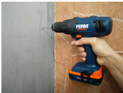
図. 2.4 固定用の穴を開ける
