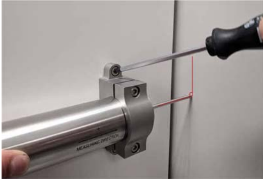
図.2.6 センサブラケットの取付けネジをしめます。
