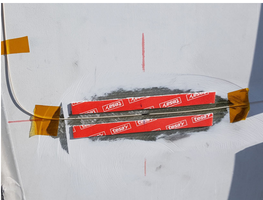
Fig. 2.8 Cadre de collage formé avec un ruban de fixation (facultatif)
