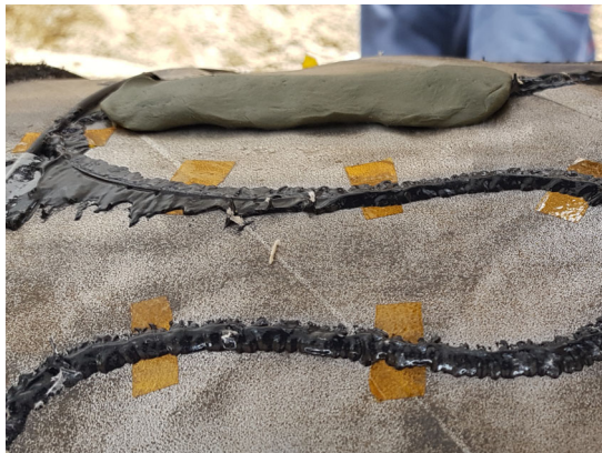
Fig. 2.16 Protection du capteur avec de l'AK22.
