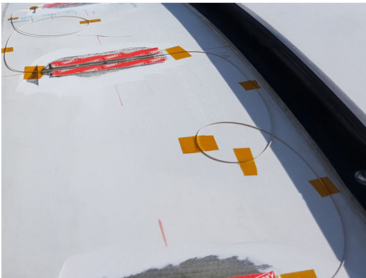
Fig. 2.18 Boucle avec la longueur de fibre en excès
