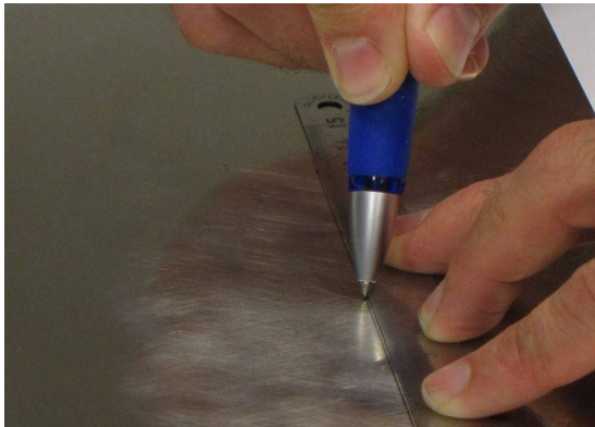
Fig. 2.6 Traçage des lignes de marquage
