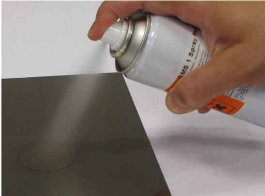
Fig. 2.1 Pulvérisation du point de mesure avec 1-RMS-SPRAY
