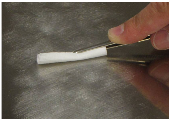
図2.4 粗面化した設置面の清掃
