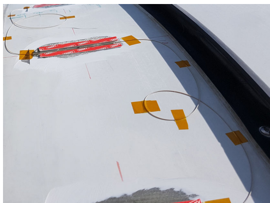
図2.18 ケーブルが長すぎる場合は、その一部をコイル状にする。
