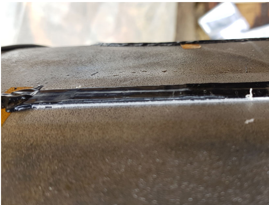
図2.15 テープを取り外した後の接着領域
