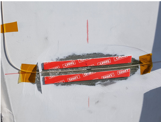
図2.8 フォームテープを使用して作成された接着枠（オプション）。
