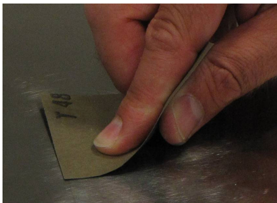
図2.3 計測対象物の表面を粗面化する
