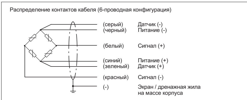
Рис. 5.1 Датчик с шестипроводным соединительным кабелем
