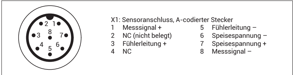
Abb. 5.2 X1, Sensoranschluss, Ansicht auf den Stecker von vorne
